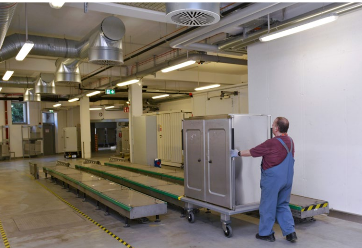
Das Fahrerlose Transportsystem befördert etwa 85 Container mit Abfall täglich in den Wertstoffhof Lobeda.
