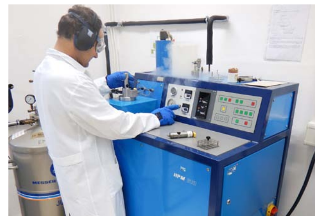
Abb. 1: Am EMZ wurde die neue Methode des Hochdruck-Einfrierens etabliert, mit der Proben für die Elektronenmikroskopie schnell und lebensnah kryofixiert werden können.
