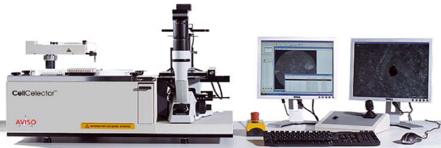
CellCelector System. Die AG Molekulare Hämostaseologie betreibt in Zusammenarbeit mit der AVISO GmbH die Weiterentwicklung des bereits in der Stammzellforschung erfolgreich eingesetzten CellCelector Systems zur besonders schonenden sterilen Hochdurchsatz-Isolation von Blutzellen unter optimalen Zellkulturbedingungen. Die Detektion unterschiedlicher Zellpopulationen erfolgt dabei automatisiert anhand von morphologischen Charakteristika der Zielzellen sowie der Detektion von spezifischen Oberflächenproteinen mittels Fluoreszenzmikroskopie. (Foto und Gerätetechnik: AVISO GmbH, Jena)
