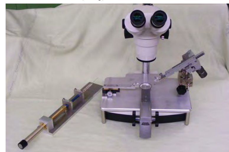
Abb.2: Oozyten-Injektionsplatz zur Injektion von RNA in positionierte Frosch-Oozyten
