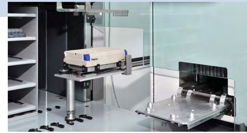
Abb. 2: Automatisierte Einlagerung von Kryoboxen, IBBJ. Fig. 2: Automated transfer of cryoboxes, IBBJ.
