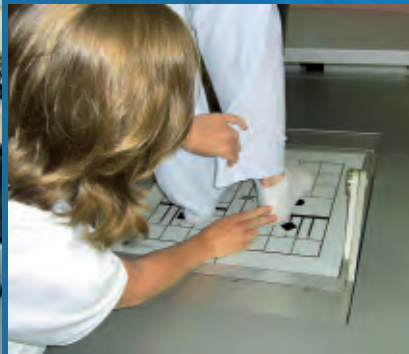
Das computergestützte Posturographiesystem liefert den Ärzten komplexe Informationen. Über eine Messplattform werden die verschiedensten Bewegungssituationen simuliert
