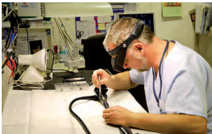
Hochkonzentriert: Thomas Scherf (Abteilung Medizintechnik) repariert ein defektes Endoskop Fotos: Schröder
