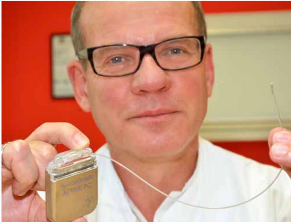
UKJ-Neurochirurg Dr. Rupert Reichart zeigt einen sogenannten Hirnschrittmacher. Der Stimulator kann auch vom Patienten nach Bedarf ein- bzw. ausgeschaltet werden. Foto: Szabó
