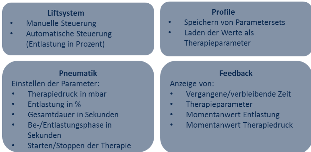
Bild 18: Neue Nutzerschnittstellen zum Liftsystem, der Patientendatenbank mit den Therapieprofilen, der Aktorik und des Haltungsfeedback
